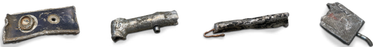
Exemples de pièces en aluminium avec bris d'alu
