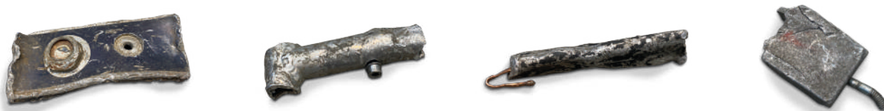
Aluminium mit Materialeinschlüssen
