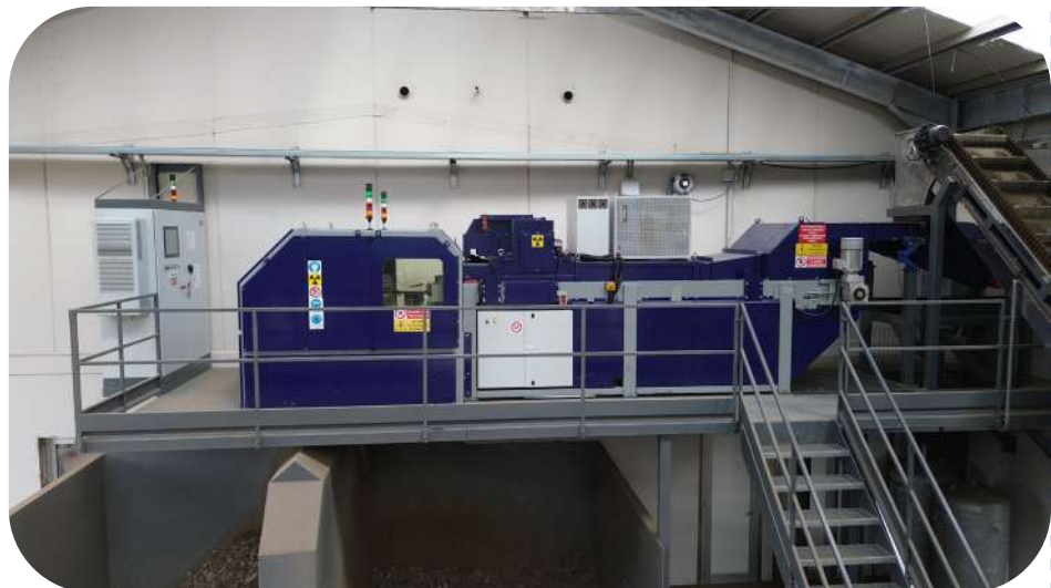
Fig. 2: X-ışını floresansı ile kombine edilmiş transmisyon (XRF-T)
