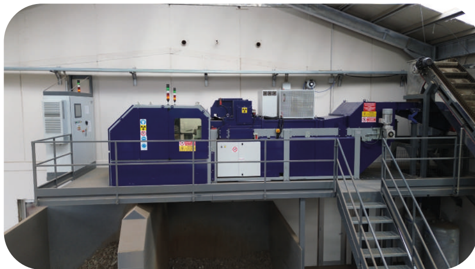
Bild 2: Röntgenkombisortierer fluoreszenz- mit Transmissionstechnik (XRF-T)
