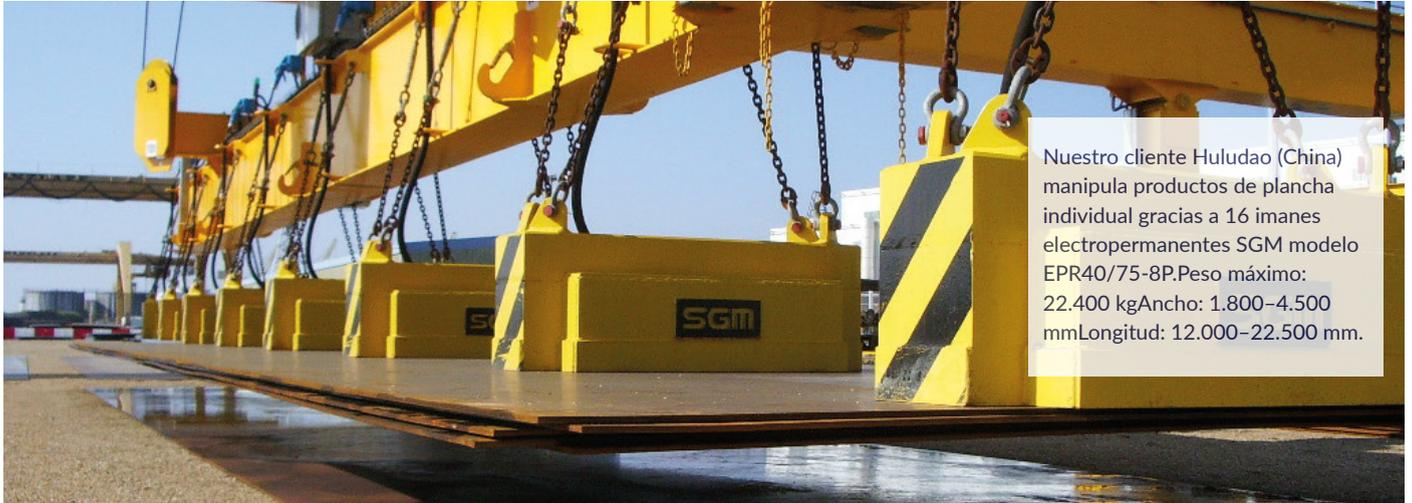
Nuestro cliente Huludao (China) manipula productos de plancha individual gracias a 16 imanes electropermanentes SGM modelo EPR40/75-8P. Peso máximo: 22.400 kg Ancho: 1.800-4.500 mm Longitud: 12.000-22.500 mm.
