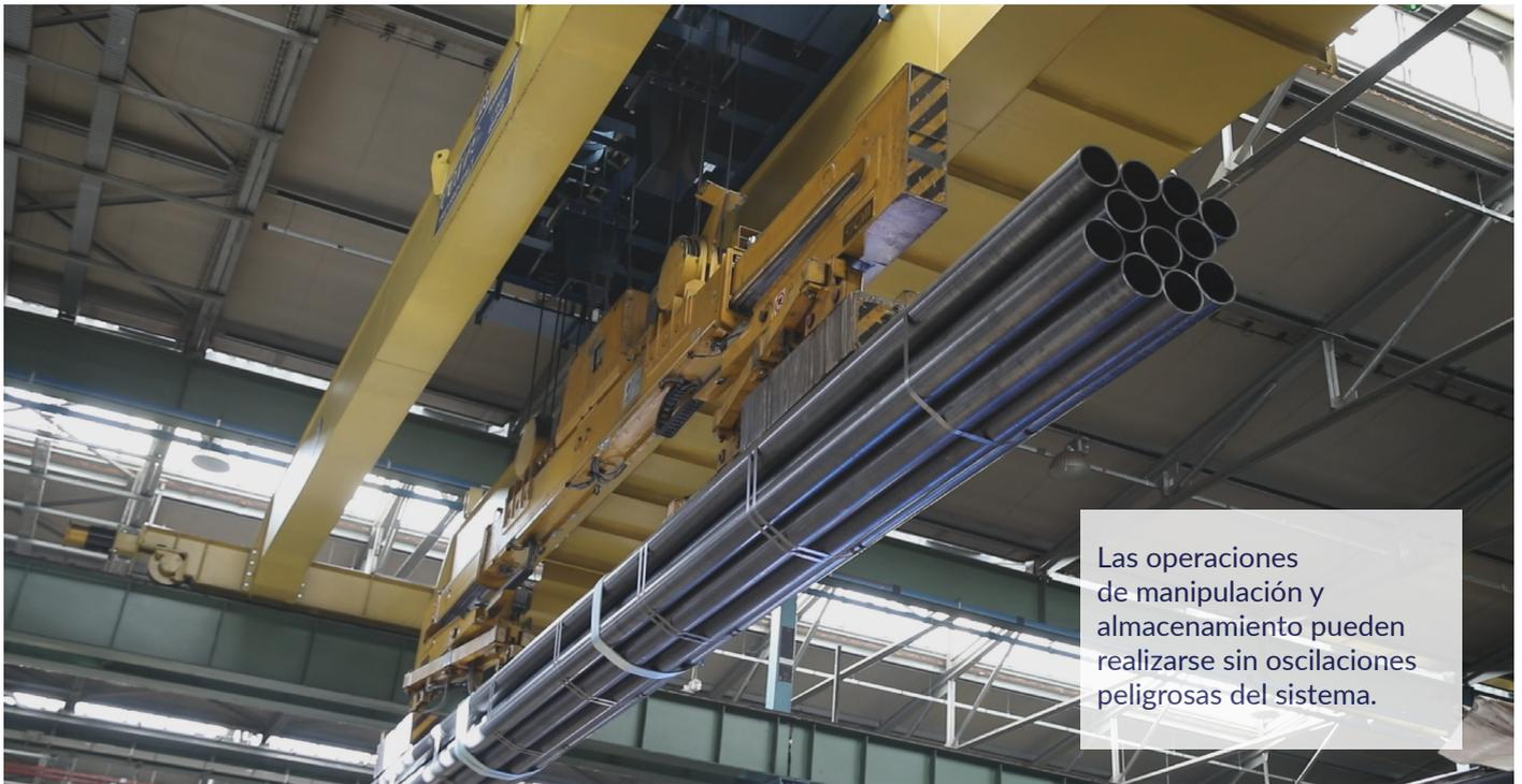
Las operaciones de manipulación y almacenamiento pueden realizarse sin oscilaciones peligrosas del sistema.
