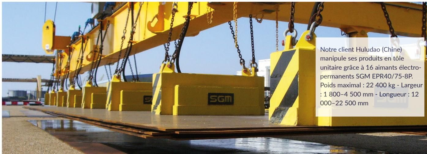
Notre client Huludao (Chine) manipule ses produits en tôle unitaire grâce à 16 aimants électro-permanents SGM EPR40/75-8P. Poids maximal : 22 400 kg - Largeur : 1 800-4 500 mm - Longueur : 12 000-22 500 mm
