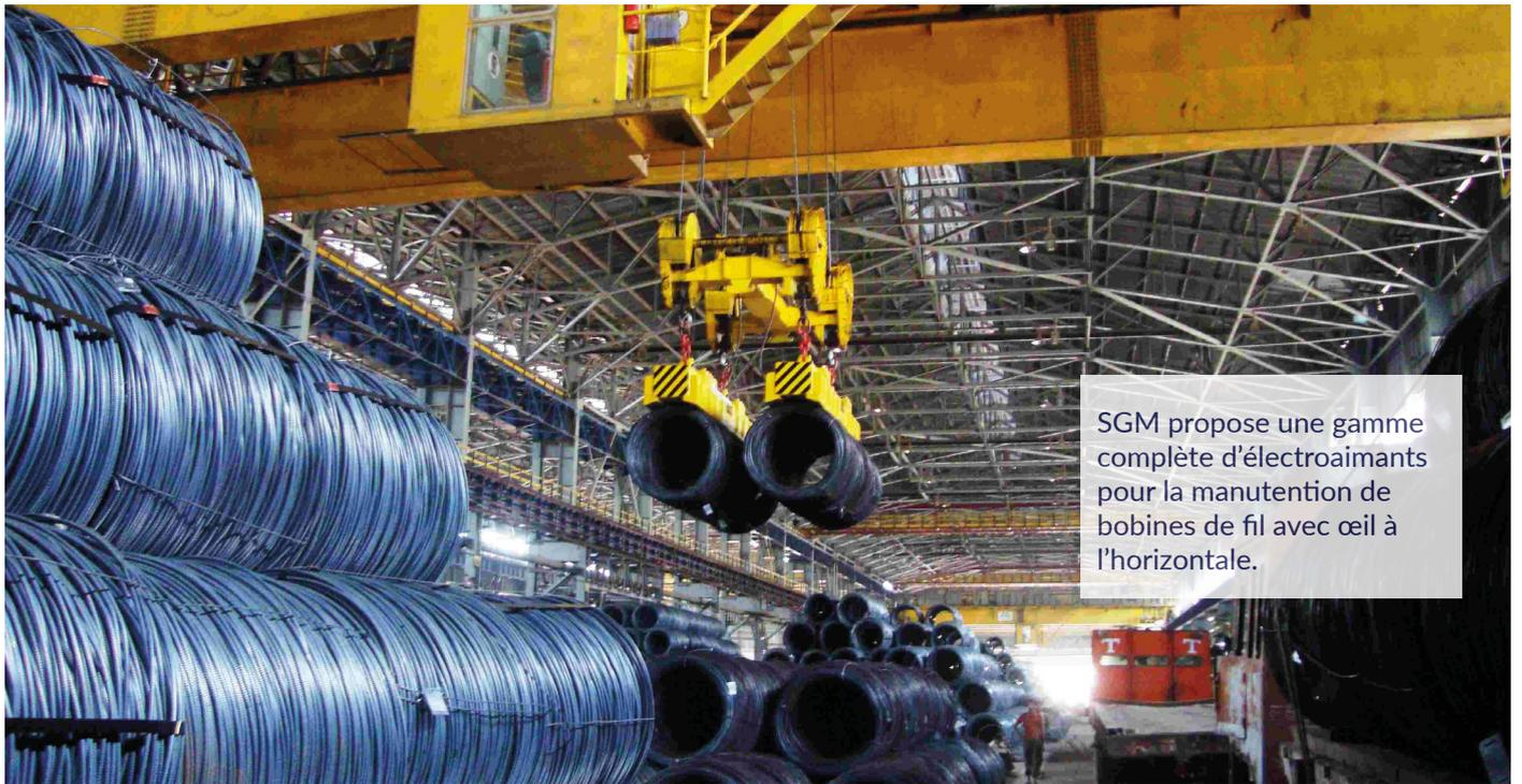
SGM propose une gamme complète d'électroaimants pour la manutention de bobines de fil avec œil à l'horizontale.
